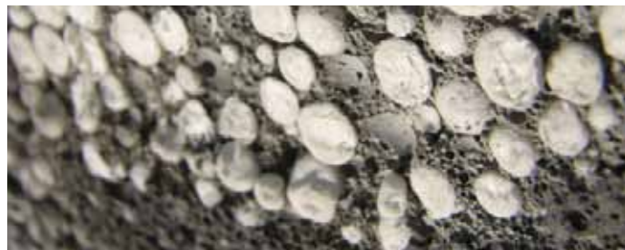
Ячеистая структура и гранулы полистирола в изделиях BAUTON служат эффективной тепловой защитой дома на долгие годы
